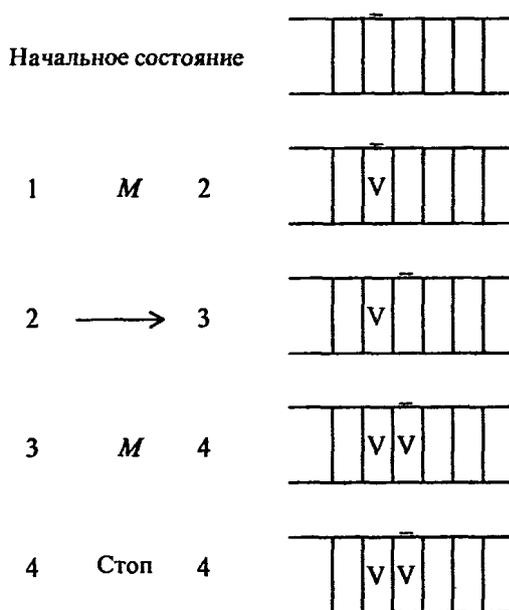
Рисунок 1.3 - Пример элемента программы машины Поста
